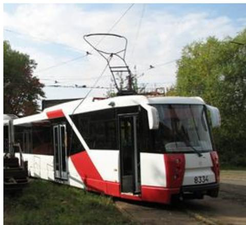
Фото 6. Дуговой токоприемник
