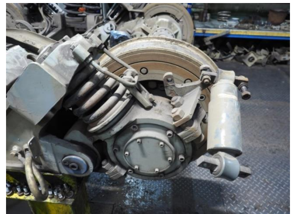
Рис. 26. Устройство первичного подрессоривания:
