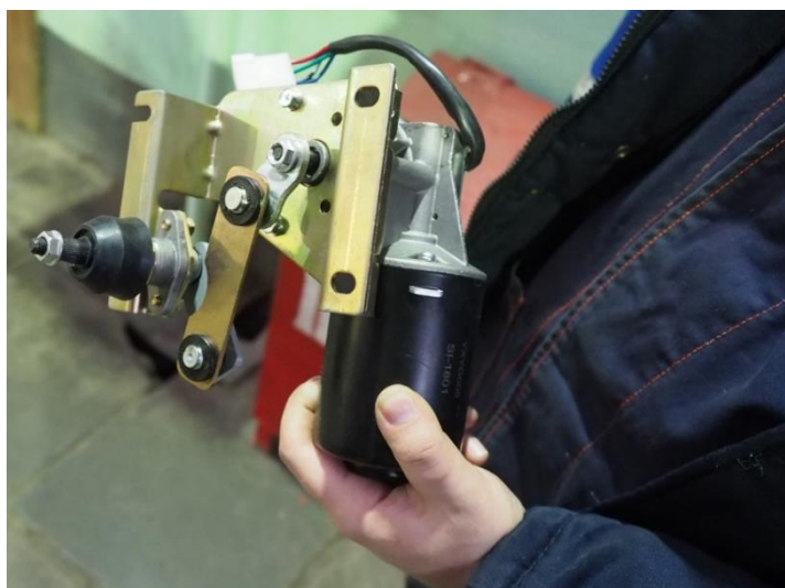
Фото 54. Электрический привод стеклоочистителя
