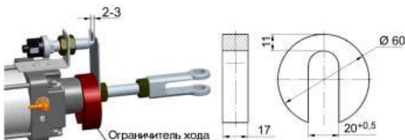
Рис. 178. Регулировка хода штока пневмоцилиндра
