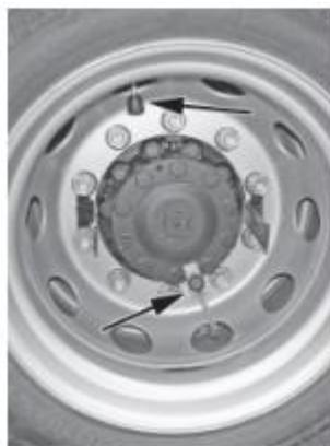
Рис. 80. Установка датчиков на двойные колеса
