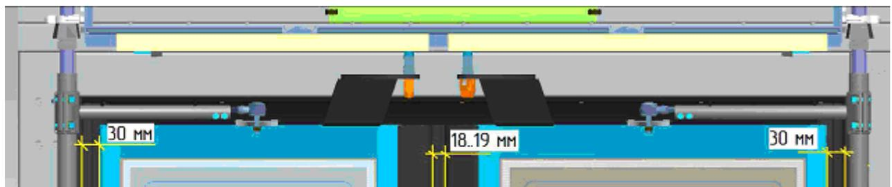
Рис. 173. Вертикальные зазоры вдоль створок
