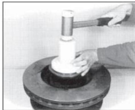
Рис. 67. Окончательную установку сальника выполняют с помощью оправки
