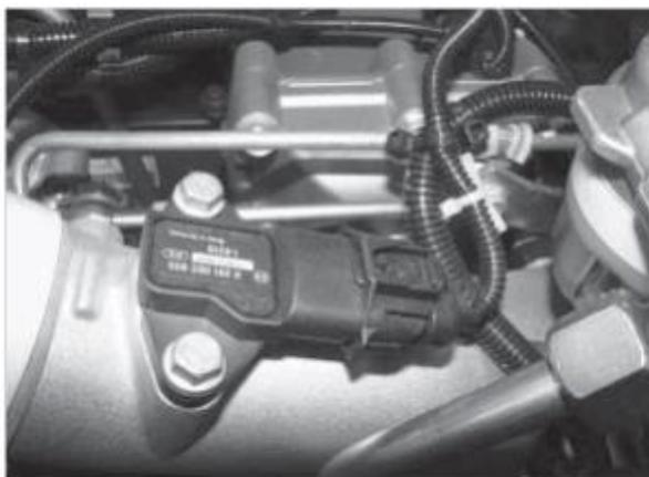
Рис. 45. Датчик давления и температуры воздуха наддува
