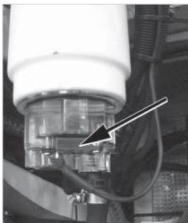
Рис. 50. Датчик наличия воды в топливе
