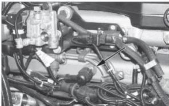
Рис. 46. Датчик температуры воздуха во впускном коллекторе
