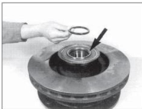
Рис. 68. Торцевую сторону кольца подшипника (указана стрелкой) смазывают герметиком
