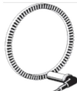
Рис. 116. Датчик частоты вращения колеса с импульсным кольцом
