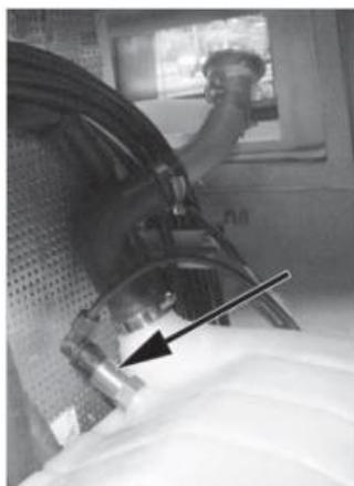
Рис. 51. Датчик аварийного уровня охлаждающей жидкости
