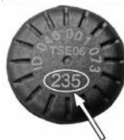
Рис. 82. Маркировка датчика давления воздуха в шине колеса
