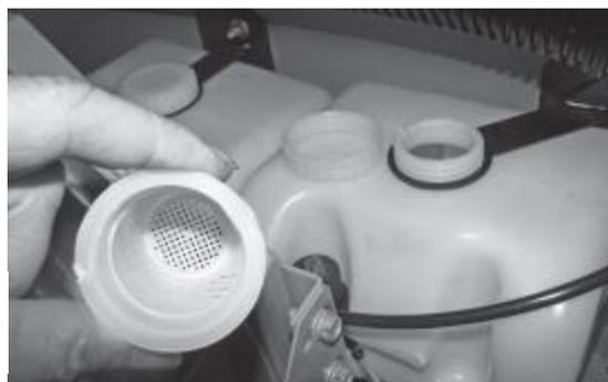
Рис. 183. Фильтр заливной горловины бачка стеклоомывателя
