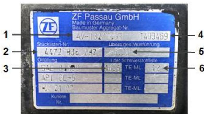
Рис. 57. Заводская табличка моста
