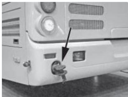
Рис. 188. Заднее буксирное устройство
