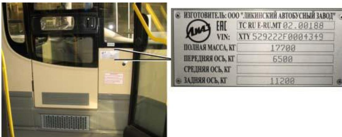
Рис. 2. Табличка с идентификационным номером автобуса на стенке кабины
