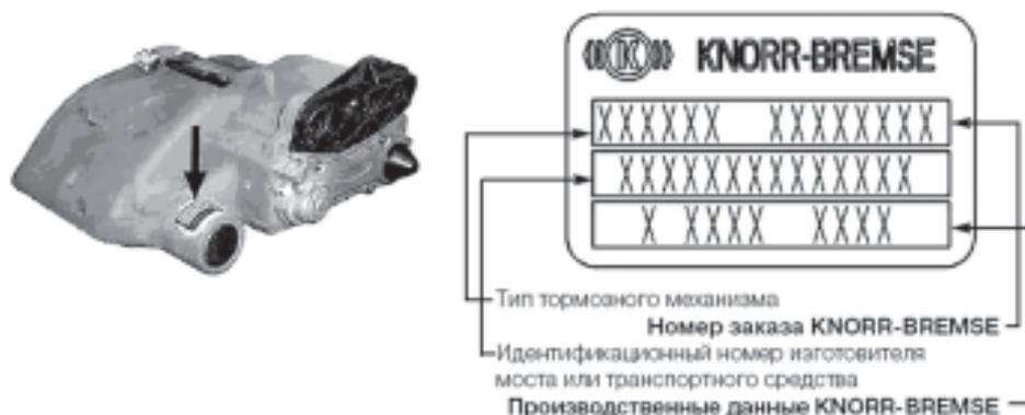
Рис. 105. Идентификационная табличка тормозного механизма
