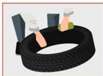
1 Тщательно промазать куском мыла, смоченного водой, верхнюю кромку обода колеса. Так же тщательно необходимо промазать монтажной пастой или влажным мылом наружную поверхность борта шины
