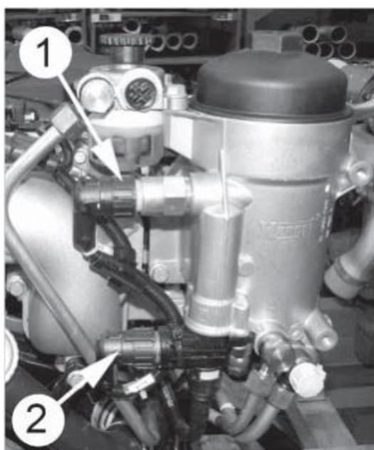
Датчик (рис. 60) установлен на корпусе фильтра тонкой очистки и замеряет давление топлива на участке низкого давления. Диапазон замера составляет от 0 до 1,5 мПа (от 0 до 15 кгс/см<sup>2</sup>).
