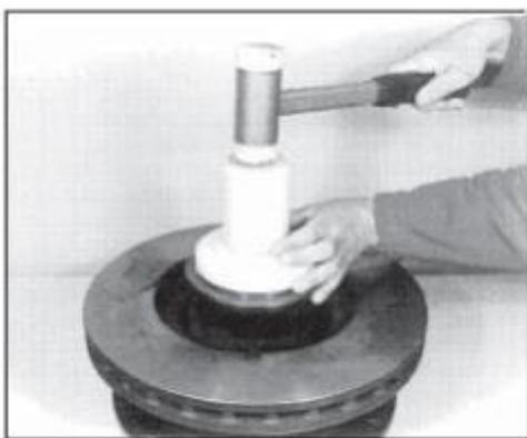
Рис. 99. Окончательную установку сальника выполнять с помощью оправки
