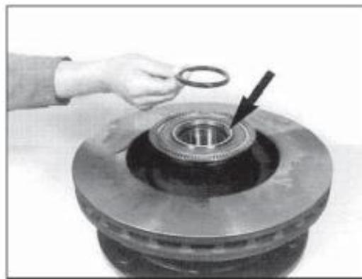
Рис. 100. Торцевую сторону кольца подшипника (указана стрелкой) смазать герметиком
