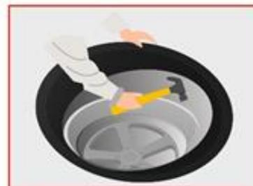
3 Противоположную сторону шины с помощью небольшой кувалды (2-3 кг) осадить в ручей обода
