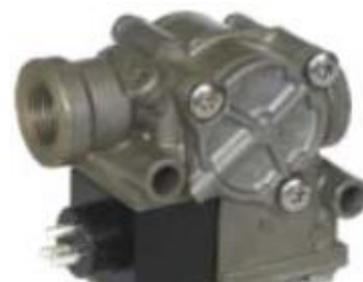
Рис. 151. Модулятор давления (внешний вид)
