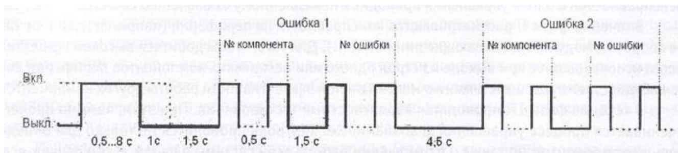
Рис. 170. Диаграмма формирования световых кодов контрольно-диагностической лампой
