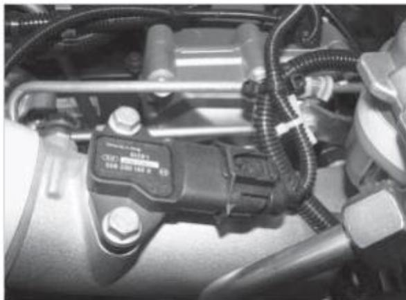
Датчик давления и температуры воздуха наддува установлен перед вводом отработанных газов системой рециркуляции, а датчик температуры воздуха во впускном коллекторе после ввода. По различию температур обоих датчиков рассчитывается приемлемый процент рециркуляции отработанных газов. Датчик давления и температуры воздуха наддува установлен на приемном патрубке воздушного коллектора.
