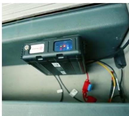
Рис. 241. Центральный блок, регистрирующий геопозицию, скорость транспортного средства, а также передающий информацию в диспетчерский центр
