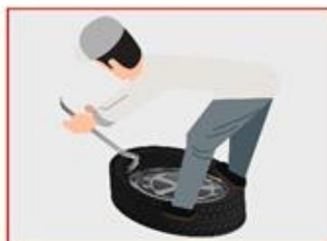
5 Утопить борт шины с одной стороны в ручей, а другую часть борта перевести за кромку обода с помощью монтажных лопаток
