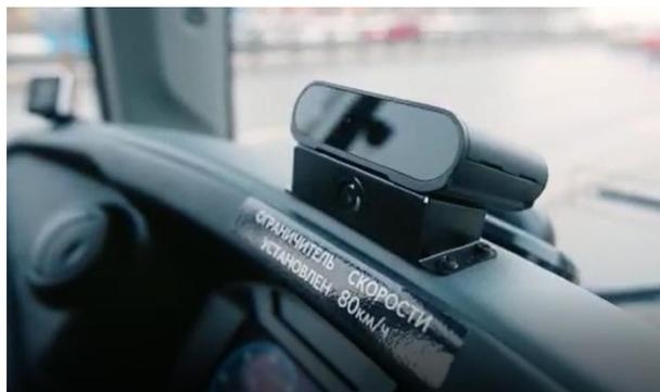
Рис. 239. Видеокамера системы «антисон», снабженная светодиодами инфракрасной подсветки
