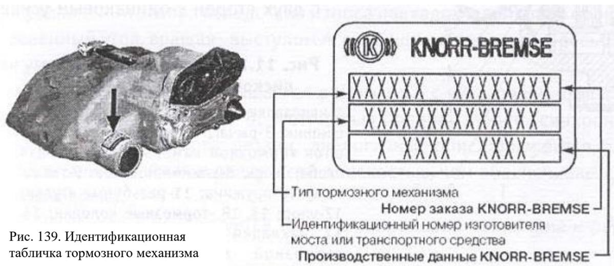
Рис. 139. Идентификационная табличка тормозного механизма
