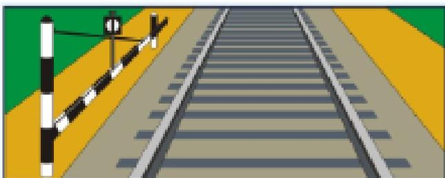
Рис. 40. «Заграждение с пути снято»
