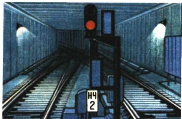
Рис. 64. Сигнал «Запрещается производить маневры»
