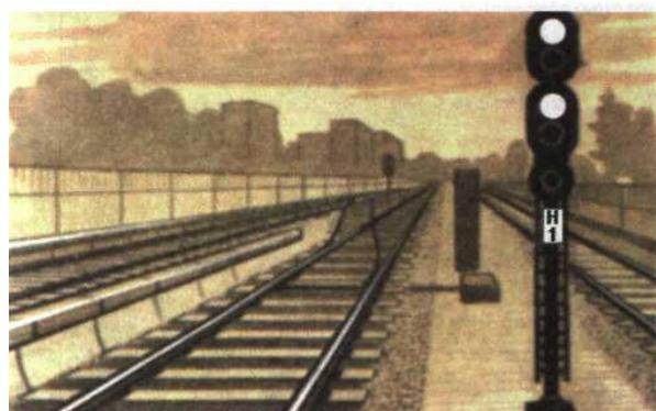
Рис. 67. Сигнал «Разрешается производить маневры до следующего светофора в направлении главных путей»
