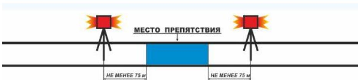
Рис. 24. Ограждение места производства работ на кривых участках пути радиусом 300 метров и менее
