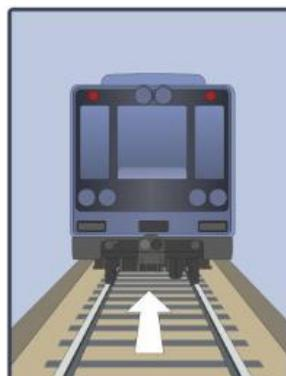
При движении поезда, как в правильном, так и в неправильном направлении при его управлении с резервного пуска голова поезда обозначается прозрачно-белыми сигналами фонарей и прожектора (при его наличии) и световыми сигналами красного цвета. Голова поезда (состава) при движении по пути соединительной ветви наземного участка, по пути наземного участка, а также при выполнении маневровых передвижений на парковых путях в светлое время суток может не обозначаться.
