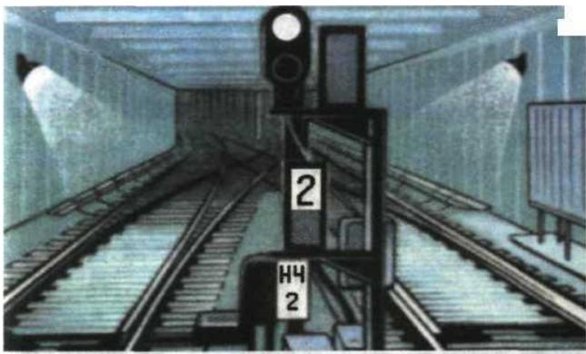
Рис. 63. Сигнал «Разрешается производить маневры маневры»
