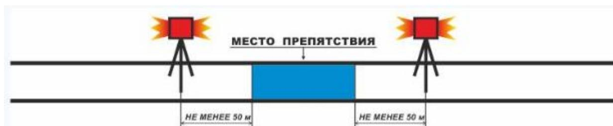
Рис. 23. Ограждение места производства работ на прямом участке
