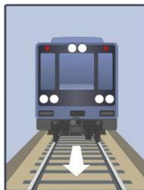
При движении поезда, управляемого машинистом не из головной кабины, голова обозначается световыми сигналами красного цвета и одним прозрачно-белым сигналом ручного фонаря, установленного в торцевой части кузова. При таком движении должно быть включено рабочее и аварийное освещение тоннеля.
