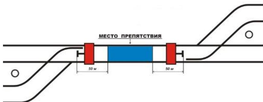
Рис. 29. Ограждение, если острия направлены к месту производства работ под напряжением
