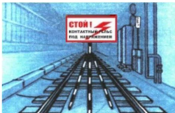
Рис. 22. Щит «Стой! Контактный рельс под напряжением»
