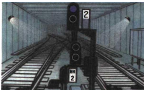
Рис. 66. Сигнал «Разрешается производить маневры по сигнальным показаниям указателя АЛС в кабине управления»
