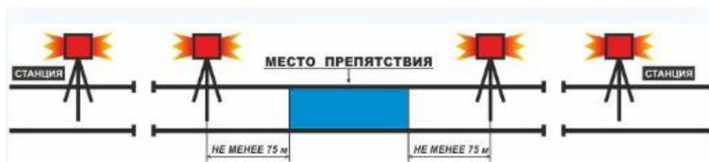
Рис. 25. Ограждение места производства работ на перегоне с уклоном более 0,040
