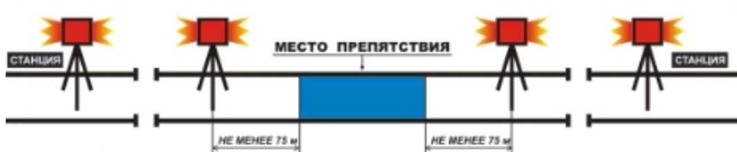
Рис. 27. Ограждение места производства работ на закрытом пути при наличии кривых участков пути радиусом 300 метров и менее
