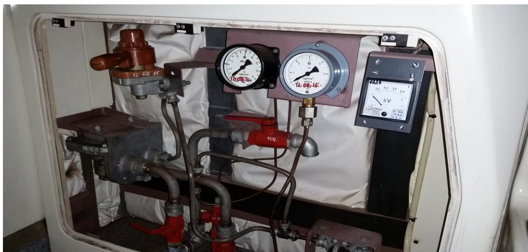
Рис. 56. Кран машиниста 013-1 (промежуточный вагон)
