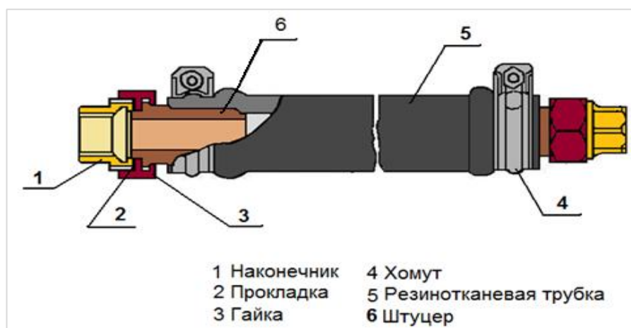
Рис. 23. Устройство соединительного рукава
