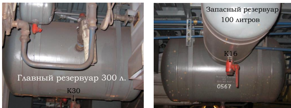
Рис. 11. Главный и запасной резервуары
