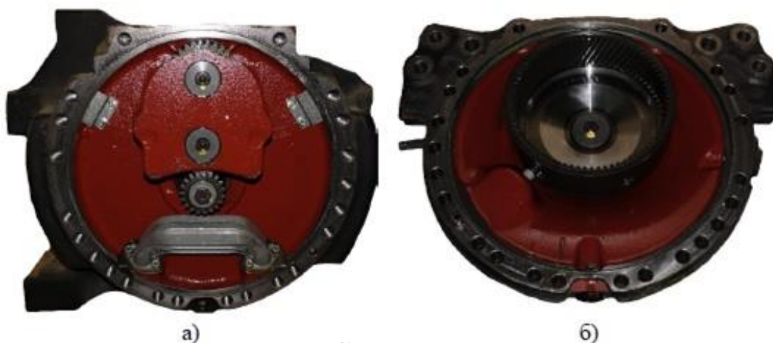
Рис. 61. Первая ступень: а) мост с электродвигателем в сборе; б) ответная часть – ступичная
