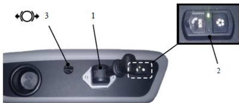
Рис. 12. Панель управления слева от водителя 1 – Рукоятка крана стояночного тормоза; 2 – Пульт Эра-Глонасс; 3 – Кран аварийного растормаживания.
