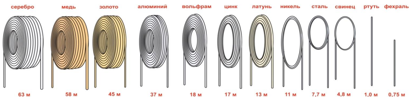
Рис. 79. Необходимая длина проводников из различных материалов для получения сопротивления 1 Ом
