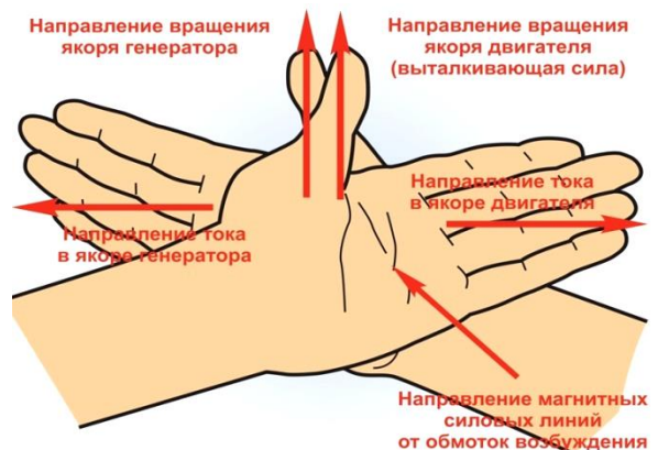
Рис. 100. Изменения, происходящие в электродвигателе при его переводе в генераторный режим
