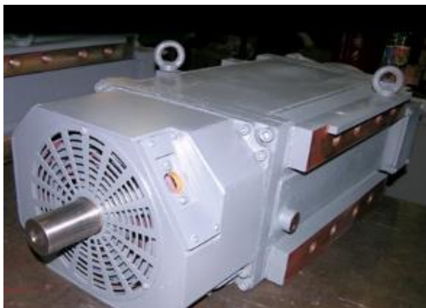
Рис. 34. Асинхронный тяговый двигатель АТД 10У1
