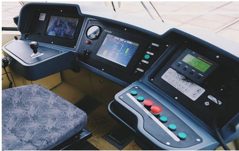
Рис. 37. Пульт управления водителя
